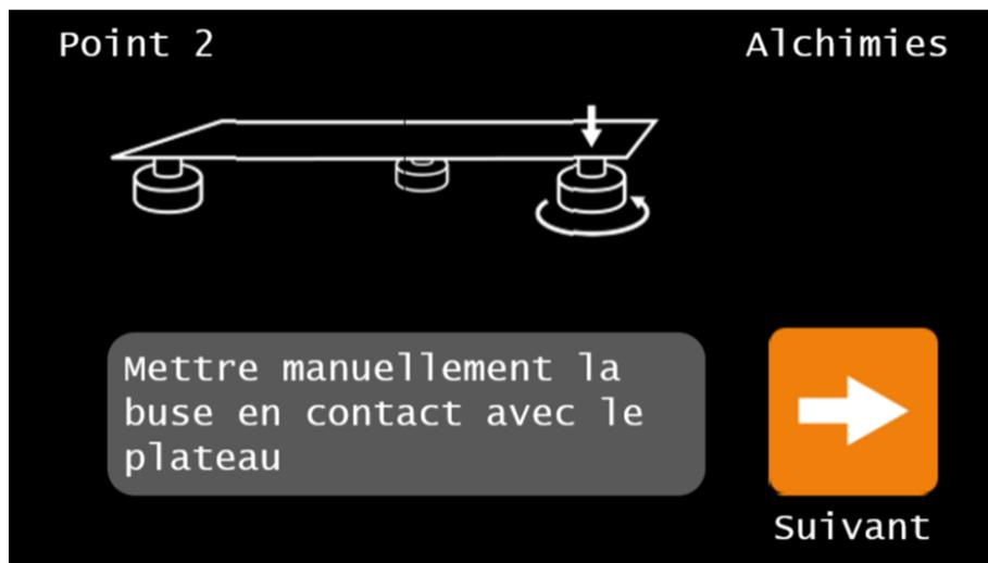
5. Réglez manuellement l'écart tête/plateau à l'aide de la molette pour amener les deux au contact : vissez pour abaisser localement le plateau, dévissez pour remonter localement le plateau
