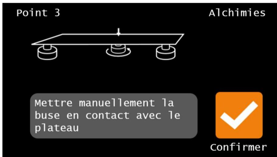
7. Réglez à nouveau manuellement l'écart tête/plateau à l'aide de la molette pour amener les deux au contact
