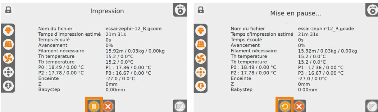
La pause peut générer un défaut visuel dû à un raccord. Il est conseillé de mettre en pause l'impression lors du remplissage de l'objet et non pas au niveau de l'enveloppe, afin de masquer le défaut à l'intérieur de l'objet.
