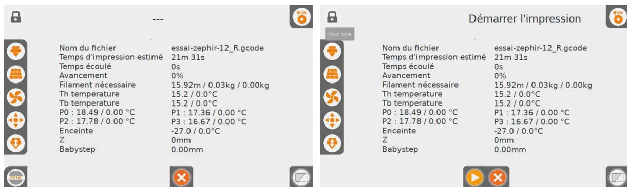
Au lancement de l'impression (PLAY), une fenêtre de confirmation des températures des zones de chauffe du plateau s'ouvre. Vérifiez et ajustez si besoin les températures avant de fermer la fenêtre pour poursuivre le lancement de l'impression.
