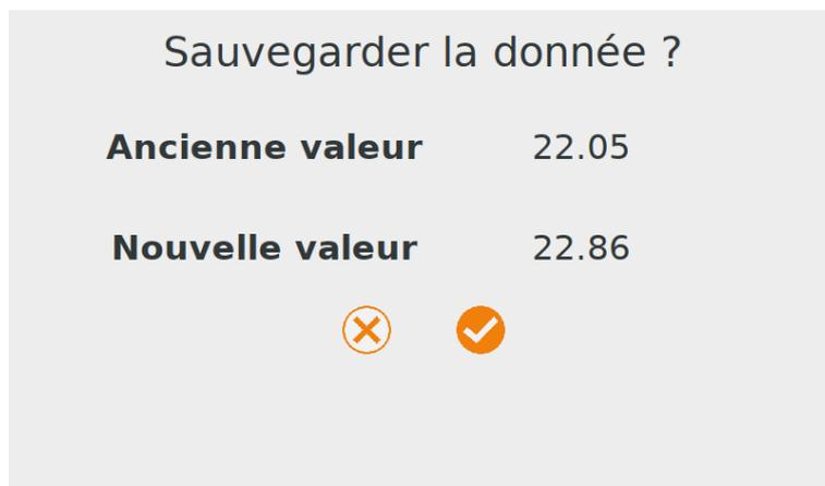
Après avoir sauvegardé la donnée de la nouvelle tête d'impression, l'imprimante effectue une prise d'origine et positionne la buse à 0.9 mm au-dessus du plateau : chauffer la buse et le plateau aux températures d'impression et vérifier l'écart buse / plateau à l'aide d'une cale d'épaisseur 0.9 mm.
