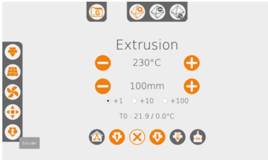
L'extrusion de filament est commandée à une température et pour une longueur à définir.
