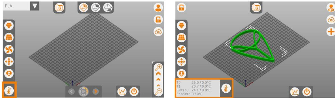
L'icône (THERMOMETRE) permet de déployer et replier un volet d'information sur les températures de consigne et mesurées des têtes d'impression, du plateau et de l'enceinte.
