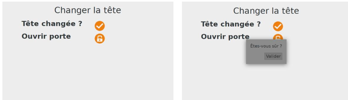
Effectuez le remplacement de la tête d'impression et validez l'étape pour poursuivre la procédure : la machine réalise à nouveau les séquences d'allumage de la LED du PLO et remonte de 20 mm. L'interface affiche alors les valeurs de décalage Z correspondant à l'ancienne tête et à la nouvelle.
