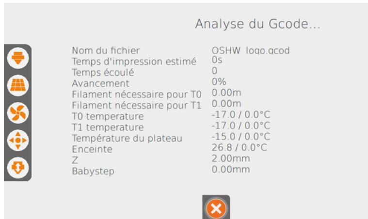
Une fois l'impression lancée, l'imprimante exécute les commandes contenues dans le fichier .gcode : contrôlez le bon déroulement de la séquence de démarrage de l'impression, ainsi que l'écrasement et l'adhérence de la 1ère couche sur la surface d'impression.
