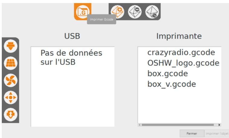
Un appui sur un fichier .gcode sélectionne ce fichier ; les boutons « Imprimer l'objet et supprimer » et « Imprimer l'objet » deviennent accessibles.
