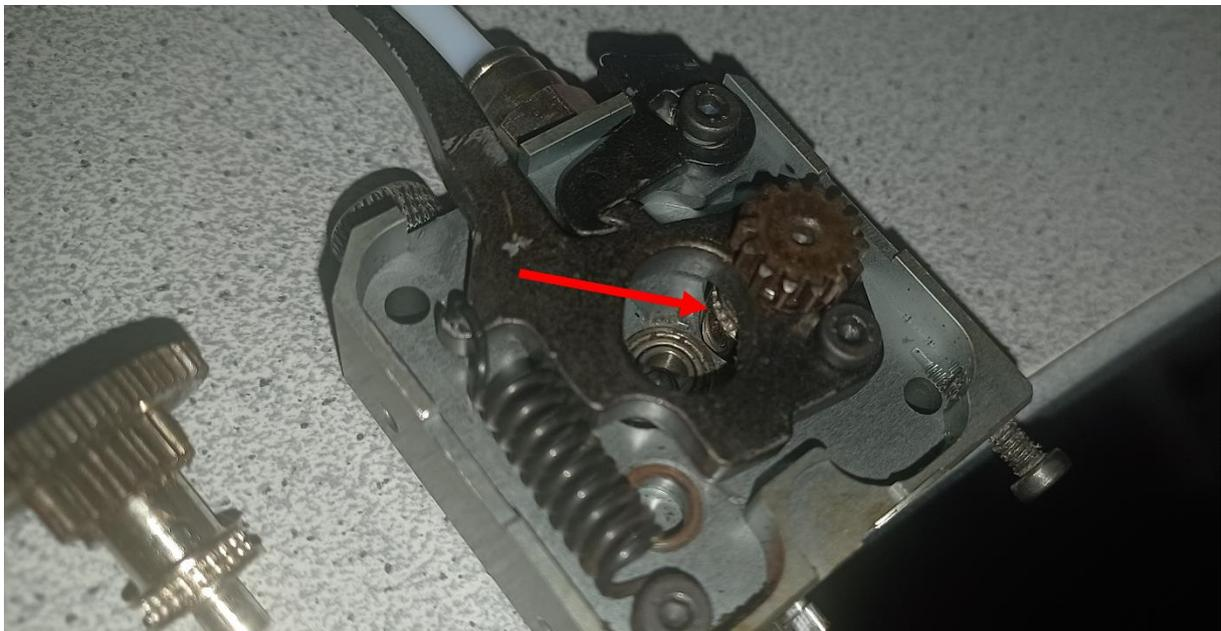
Une fois les composants nettoyés, vous pouvez les graisser avec un pinceau et une graisse blanche au lithium (étape à réaliser une fois par an).
