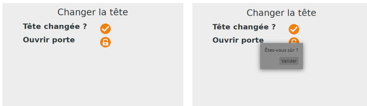
Effectuez le remplacement de la tête d'impression et validez l'étape pour poursuivre la procédure : la machine réalise à nouveau les séquences d'allumage de la LED du PLO et remonte de 20 mm.
