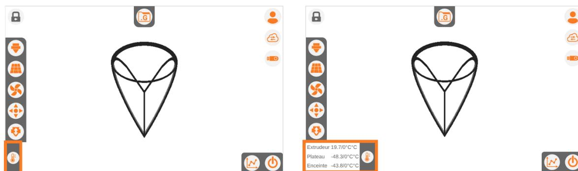
L'icône (THERMOMETRE) permet de déployer et replier un volet de retour d'information sur les températures de consigne et mesurées des têtes d'impression, du plateau et de l'enceinte.
