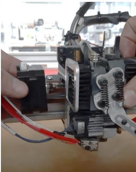
T1 étant en position haute, commencez par visser la vis M3 basse (a) ; basculez manuellement T1 en position basse pour pouvoir visser la vis M3 haute (b).
