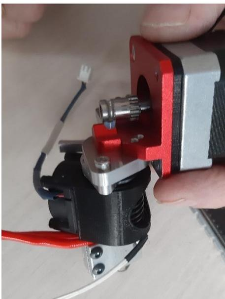
Coupez l'autre côté du tube PTFE en suivant l'angle de la pièce métallique ; le tube PTFE forme une pointe qui viendra récupérer l'extrémité du filament immédiatement après les pignons lors d'une impression.
