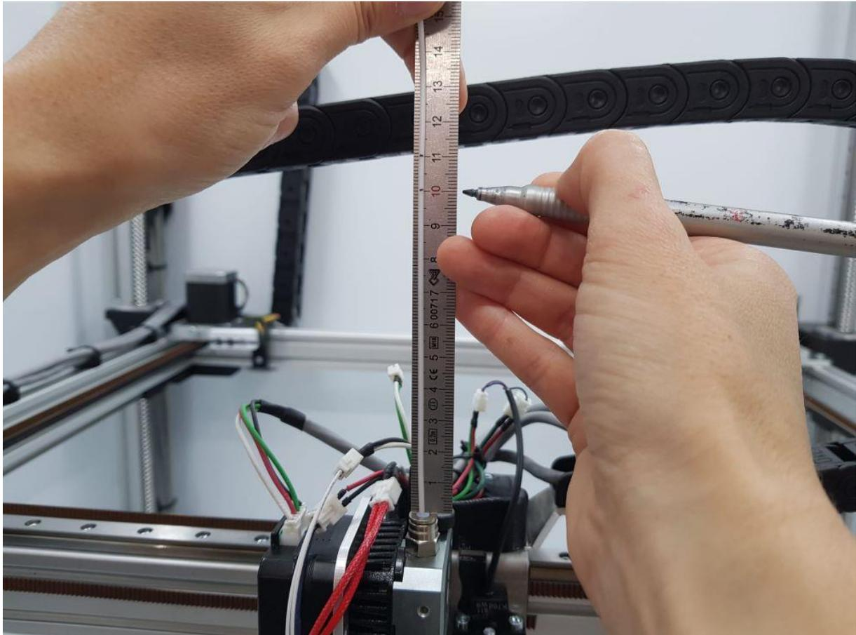
3. Via l'interface, commandez l'extrusion de 100 mm de filament à la température d'impression du matériau chargé
