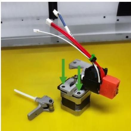
Sur la machine, clipsez la cale imprimée dans le support aluminium fixé sur le chariot X : l'ouverture de la cale est orientée vers le bas.
