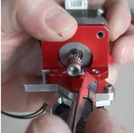
Fixez à nouveau le levier de l'extrudeur et vérifiez l'alignement et la rotation des 2 pignons.
