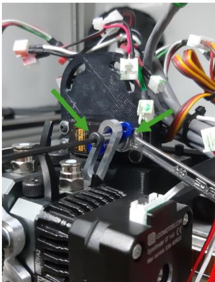
La vis ne doit pas être en tension sur la patte une fois la bascule effectuée, dans un sens ou dans l'autre.
