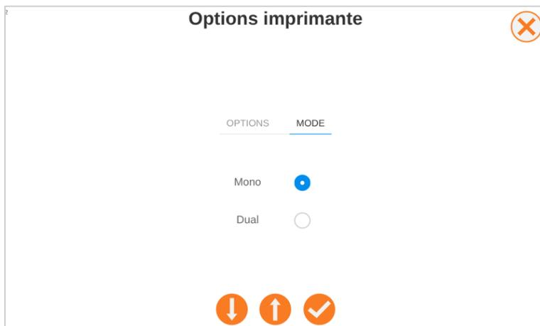
Un contrôle de l'[extrusion](#) et de l'[écart buse / plateau](#) est nécessaire avant toute première impression à la suite du changement de mode !
