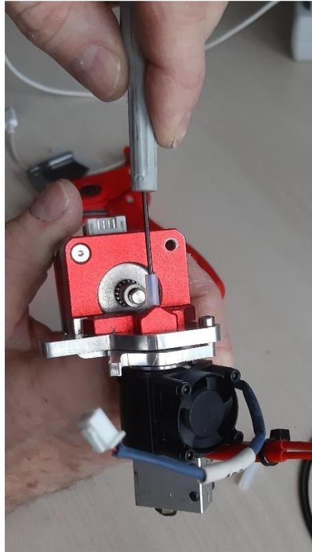
Retirez à nouveau la tête d'impression de l'extrudeur pour retirer le tube PTFE et contrôlez que l'opération précédente a permis de positionner la rondelle correctement par rapport à la valeur mesurée à la jauge de profondeur ( $\pm 1$  mm).
