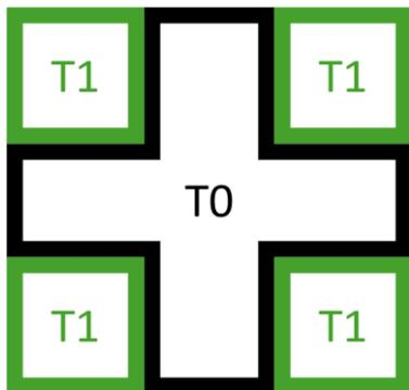
Observez le résultat sur le plateau d'impression et ajustez les valeurs d'offset X T1 et Y T1 via l'interface selon la logique suivante :
