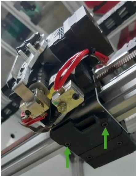
Débranchez les connecteurs des deux moteurs d'entraînement et ceux des deux têtes d'impression (ventilateur, cartouche chauffante, sonde de température) en vous aidant si besoin des accessoires fournis pour ne pas tirer sur les câbles.
