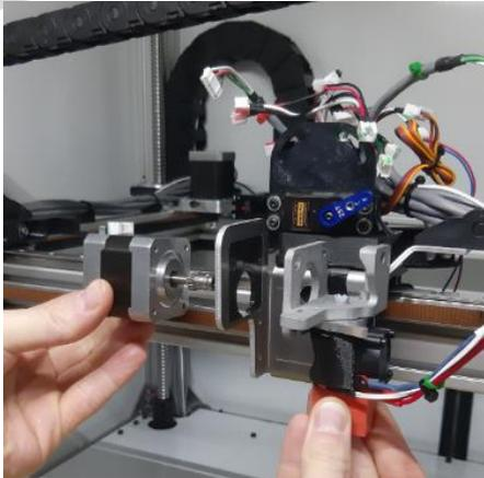
Serrez la vis perpendiculaire aux 2 précédentes sur le support en aluminium (a), puis serrez les 2 vis précédentes (b).
