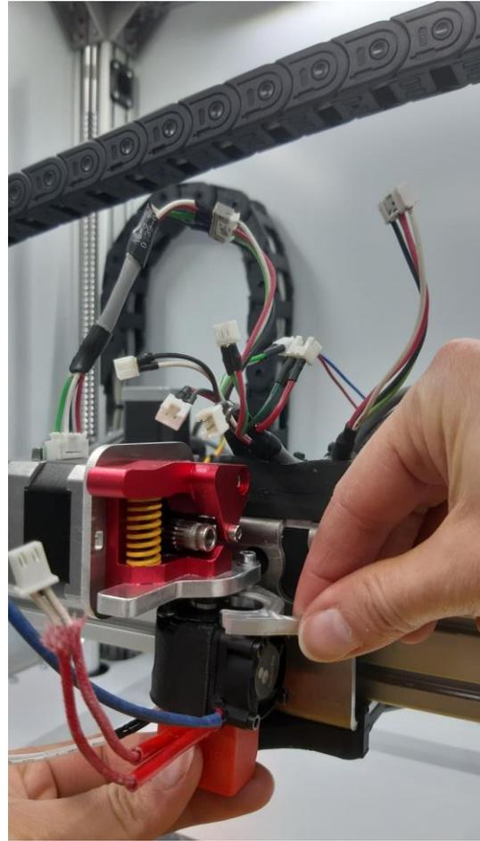
Une fois la tête retirée de l'extrudeur, retirez la vis M4 de maintien du ressort (si elle est présente) à l'aide d'une clé hexagonale de 3.0 mm pour pouvoir retirer le ressort. Retirez ensuite le levier de l'extrudeur.
