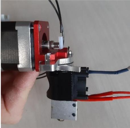
A l'aide d'un cutter, coupez en biais le tube PTFE et le filament (dont la présence empêche des copeaux de PTFE de tomber au fond du baril et dans la buse) ; le bord du tube doit lécher le diamètre extérieur du pignon d'entraînement.
