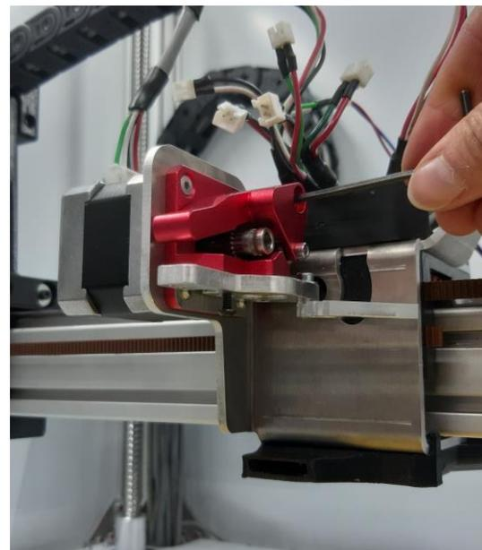
Avec une clé hexagonale de 2.5 mm, retirez ensuite les vis de la platine qui porte le levier de fixation de la tête d'impression.
