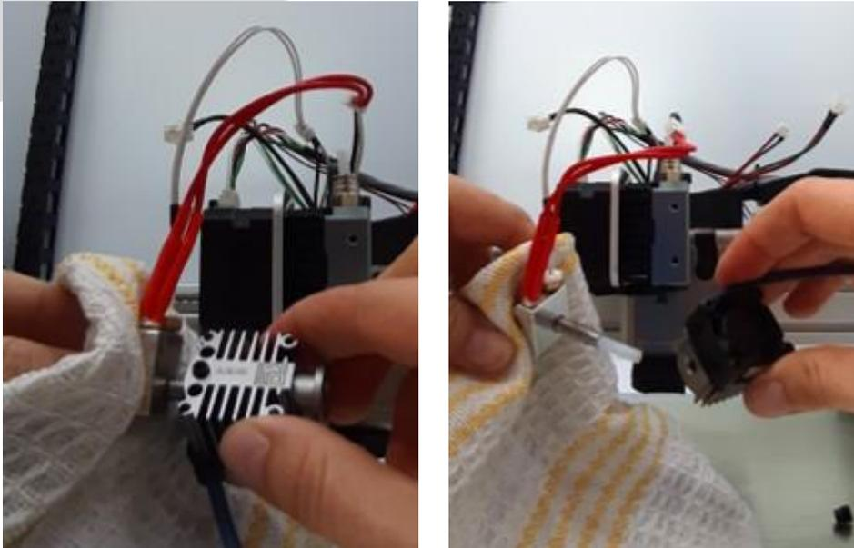
A l'aide d'une pince plate, retirez le tube PTFE et contrôlez visuellement qu'aucun résidu ne reste au fond du baril ; sinon retirez la matière à l'aide d'un outil fin, tel qu'une clé allen 1,5 mm.
