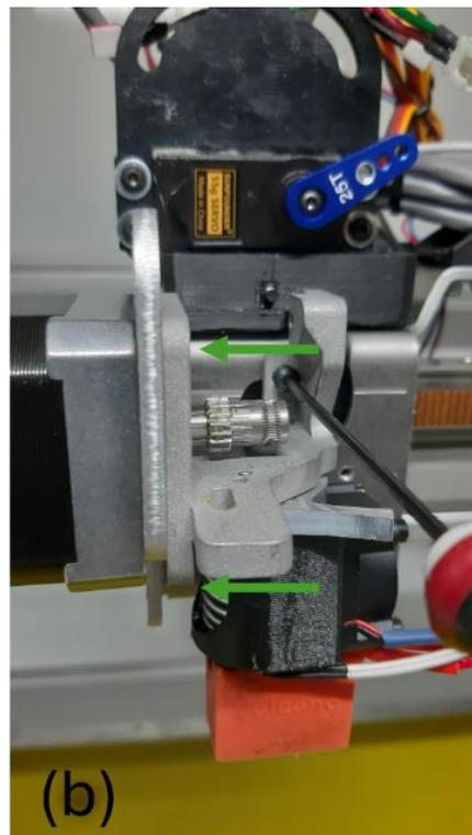
Vissez le levier du système d'entraînement sur le moteur à travers la cale imprimée à l'aide de la clé hexagonale 2,5 mm.
