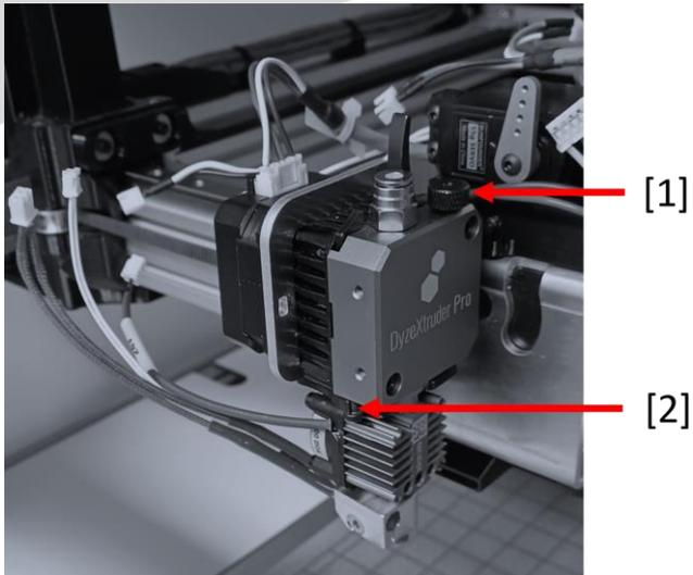
Une fois la tête retirée de l'extrudeur, retirez les 2 vis M3 [1] à l'aide d'une clé hexagonale de 2.5 mm.
