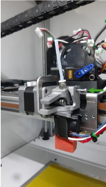
Installez le ressort du levier grâce à la vis (clé hexagonale 2,5 mm) et l'écrou nylstop (clé plate 5,5 mm) ; l'écrou doit entrer en contact avec le dessus du levier sans exercer de pression.
