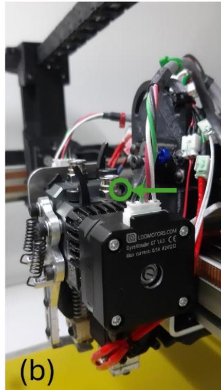
Selon la position de l'axe du servo-moteur, laissez T1 en position basse ou basculez T1 en position haute : récupérez la vis et l'écrou nylstop du sachet pour fixer la patte de bascule du bloc DUAL sur le perçage fileté de l'axe du servo-moteur.
