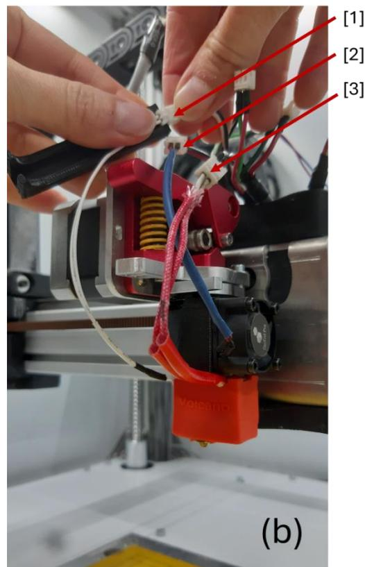
Desserrez la vis qui retient la tête d'impression à l'aide d'une clé hexagonale de 2.5 mm ; un tour de clé suffit à libérer la tête. Basculez le levier pour sortir la tête.
