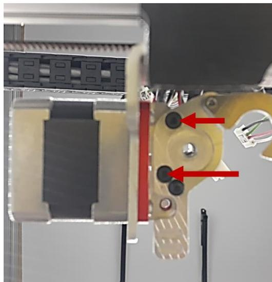
Débranchez le connecteur du moteur d'entraînement : câbles fins 4 couleurs, petit connecteur 4 pins.
