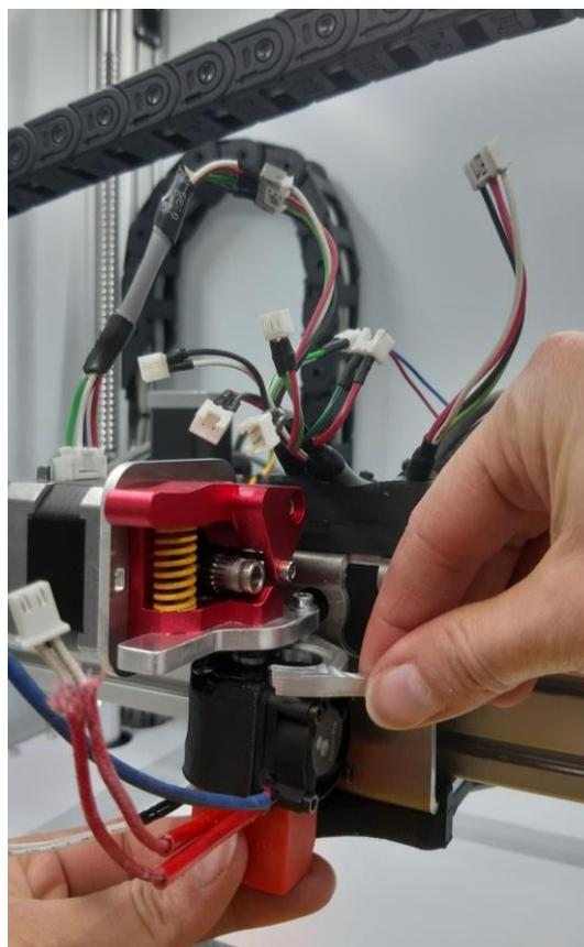
Installez la nouvelle tête dans le levier, puis resserrez la vis de maintien avec la clé hexagonale jusqu'à ce que la tête ne puisse plus tourner sur elle-même. Rebranchez les connecteurs en respectant le code couleurs.
