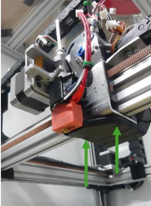
Débranchez les connecteurs du moteur d'entraînement et ceux de la tête d'impression (ventilateur, cartouche chauffante, sonde de température) en vous aidant si besoin des accessoires fournis pour ne pas tirer sur les câbles.
