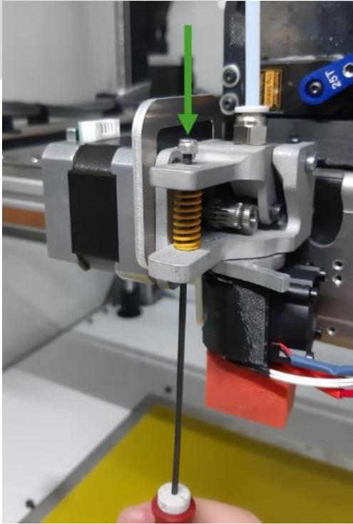
Toujours à l'aide de la clé hexagonale 2,5 mm, retirez la vis de fixation du levier et retirez le levier du système d'entraînement.
