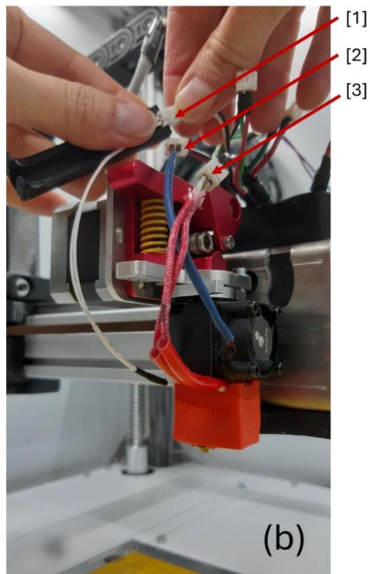
Au niveau de l'extrudeur, desserrez la vis qui retient la tête d'impression à l'aide d'une clé hexagonale de 2.5 mm. Basculez le levier pour retirer la tête.
