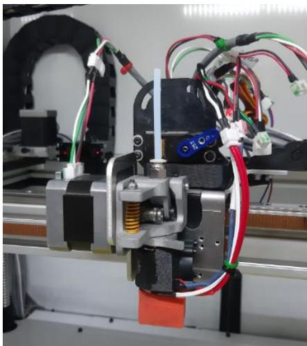
Vissez le guide flux MONO de la turbine sous le support en aluminium à l'aide de la clé hexagonale 2,5 mm.
