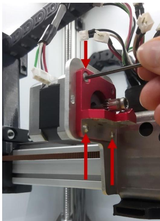
Rassemblez le moteur E et le levier de l'extrudeur : nettoyez à l'aide d'une brosse fine non métallique les copeaux de matière coincés entre les dents du pignon et du galet. Profitez-en pour inspecter l'usure des dents : une usure importante entraîne un glissement du filament sur le système d'entraînement et donc une sous-extrusion à l'impression. Le pignon et / ou le galet doivent alors être remplacés.
