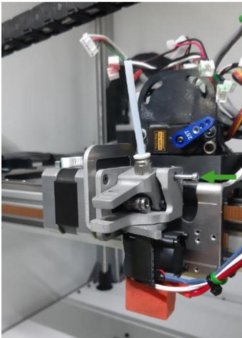
Retirez ensuite avec une clé hexagonale 2,0 mm la vis qui permet de verrouiller le système d'entraînement sur le support en aluminium (a). Enfin, avec cette même clé, retirez les 2 dernières vis qui maintiennent le système d'entraînement sur le moteur de part et d'autre de la cale imprimée (b).
