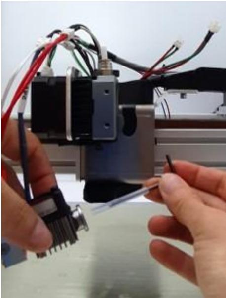
**Cas n°1 – le tube PTFE sort en totalité du barrel** : vous pouvez alors couper la chauffe de la tête et patienter jusqu'au refroidissement, avant d'insérer un nouveau tube pré-coupé à la longueur correspondant à votre tête d'impression ; resserrez la vis de maintien du tube PTFE sur le dessus de la tête.
