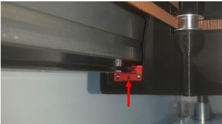
3. Agitez bien le spray avant usage ; insérez l'embout de précision dans l'orifice de graissage et placez un chiffon à proximité pour absorber un maximum de projections au moment d'appuyer sur le spray.
