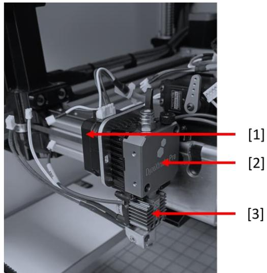
Débranchez les connecteurs de la tête d'impression : cartouche chauffante [1], sonde de température [2], ventilateur [3]
