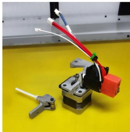
À l'aide de la clé hexagonale 2,0 mm, retirez les 2 dernières vis qui maintiennent le système d'entraînement au moteur de part et d'autre de la cale imprimée.
