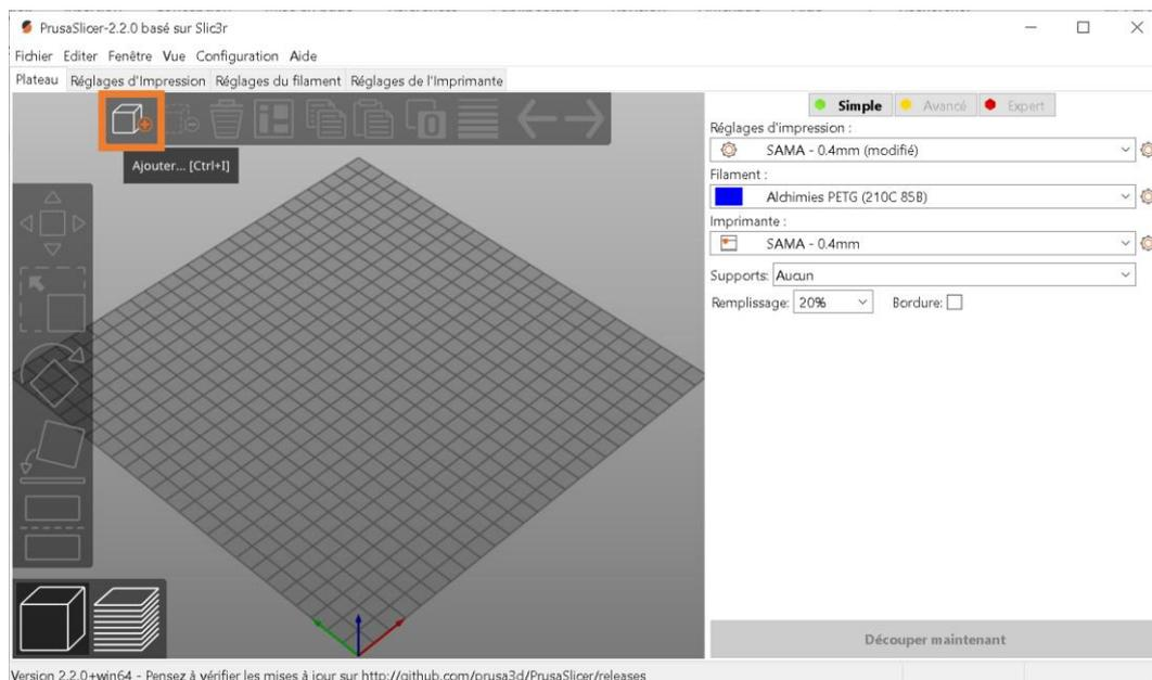
Importez le fichier de configuration Imprimante / Filament en cohérence avec l'objet à imprimer (**Fichier > Importer > Importer la Configuration...**). Ajustez éventuellement des paramètres en fonction de la géométrie et des contraintes d'utilisation de l'objet à imprimer.
