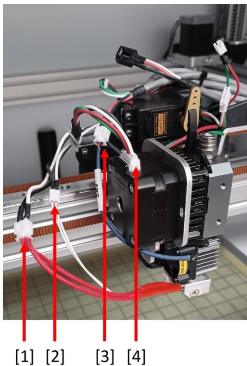
Desserrez la molette [1] qui retient la tête d'impression ; il est possible de s'aider d'une clé hexagonale de 2.0 mm. Basculez le levier [2] pour sortir la tête.
