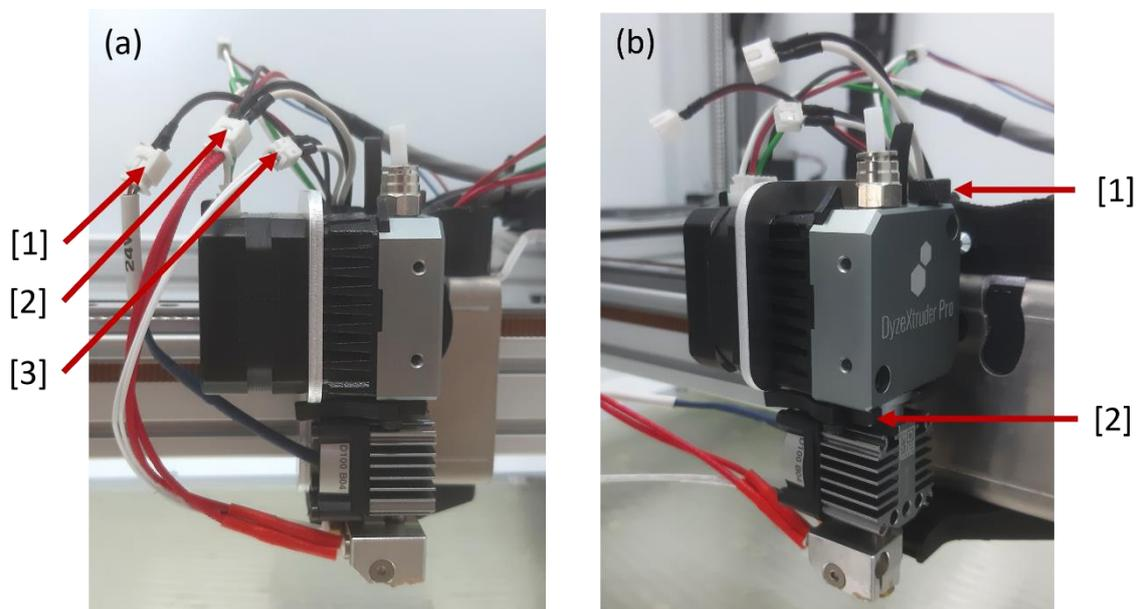
Installez la nouvelle tête dans le levier, puis resserrez la molette jusqu'à ce que la tête ne puisse plus tourner sur elle-même. Rebranchez les connecteurs en respectant le code couleurs.
