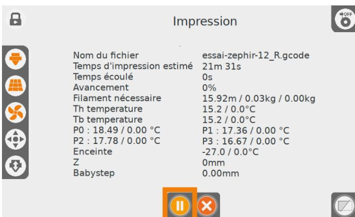
L'imprimante termine d'exécuter les commandes en mémoire et s'arrête au bout de quelques instants ; la tête se déplace afin de libérer le volume d'impression.
