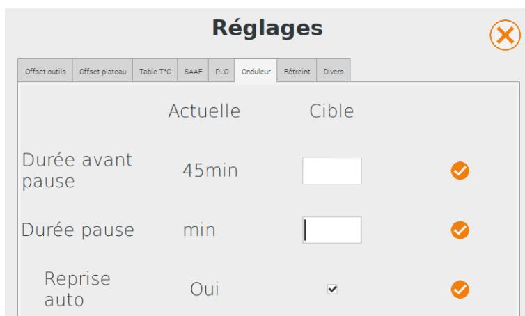
Durée avant pause : indique combien de temps l'imprimante fonctionne sur onduleur en cas de coupure de courant ; la chauffe du plateau stoppe au moment de la coupure et un message informe l'utilisateur de la situation. Si le courant est rétabli avant la fin de ce temps, le plateau chauffe à nouveau à sa température cible et l'impression se poursuit normalement.
