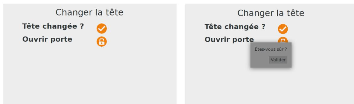
Effectuez le remplacement de la tête d'impression et validez l'étape pour poursuivre la procédure : la machine réalise à nouveau les séquences d'allumage de la LED du PLO et remonte de 20 mm. L'interface affiche alors les valeurs de décalage Z correspondant à l'ancienne tête et à la nouvelle.
