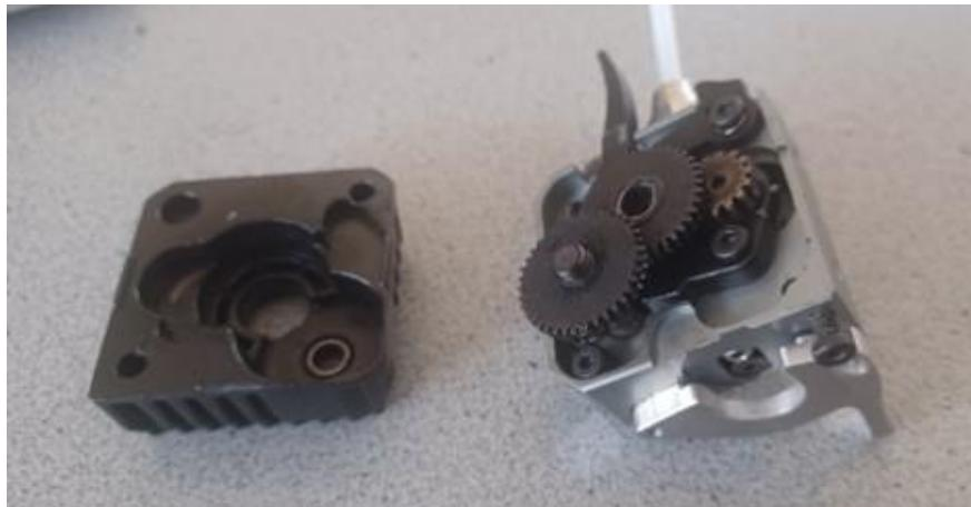
A l'aide d'un tournevis hexagonal de 2.0 mm, retirez la vis qui maintient le fût situé sous l'extrudeur : il est possible que le fût tombe de lui-même ; si le fût reste en place, insérez un morceau de filament depuis l'entrée de l'extrudeur et poussez-le manuellement jusqu'à faire sortir le fût.
